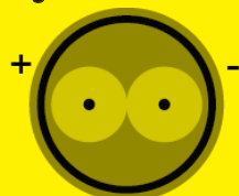
Fig. 7.12.5.2.2.1.C Conducteur de protection concentrique
