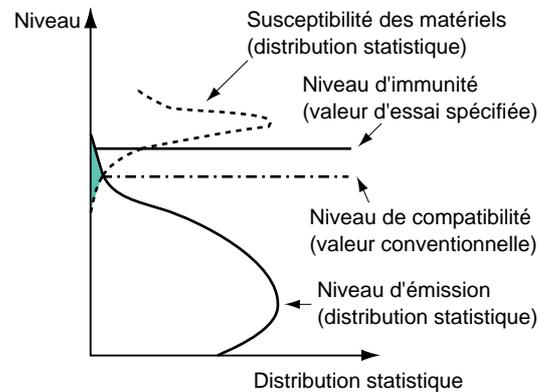
**fig. 1** : positionnement des niveaux en Compatibilité électromagnétique.
