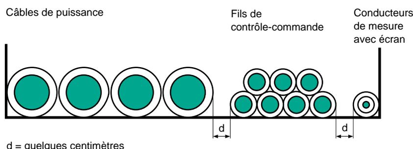
**Fig. 22** : un exemple de cheminement de câbles.
