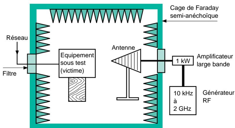
**Fig. 31** : disposition typique de test dans une cage de Faraday. Les mesures se font en deux étapes :
