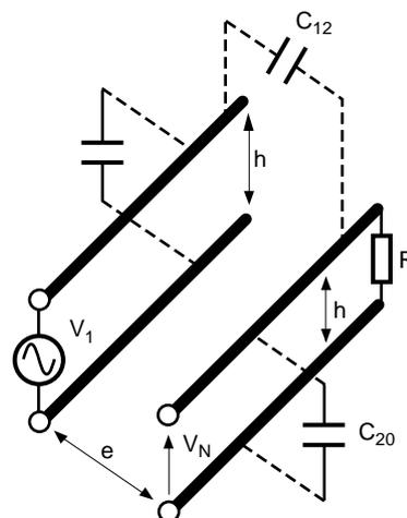
**Fig. 15** : une variation brusque de tension  $V_1$  entre deux fils génère un champ qui, à faible distance, peut être considéré comme principalement électrique, et induire une tension  $V_N$  dans une autre structure filaire qui lui est parallèle ; ce mode de couplage est appelé diaphonie capacitive.
