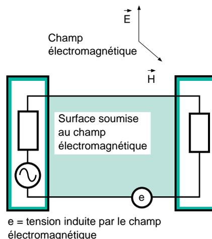
**Fig. 11** : un exemple de couplage champ à câble de mode différentiel.
