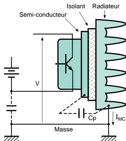
**Fig. 7 :** la capacité parasite du radiateur de refroidissement des composants électroniques, un élément pris en compte dans la conception des « bras d'onduleur ».
