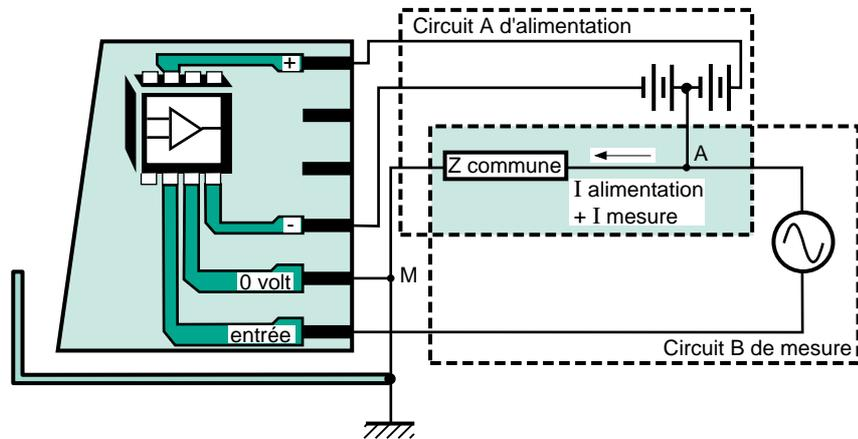
**Fig. 13 :** les mesures effectuées par l'amplificateur opérationnel seront erronées car un courant perturbateur dans le circuit A (d'alimentation) suffit pour créer dans le circuit B (de mesure) des tensions perturbatrices.
