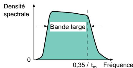
Fig. 5 : exemple de caractéristiques spectrales de perturbations.
