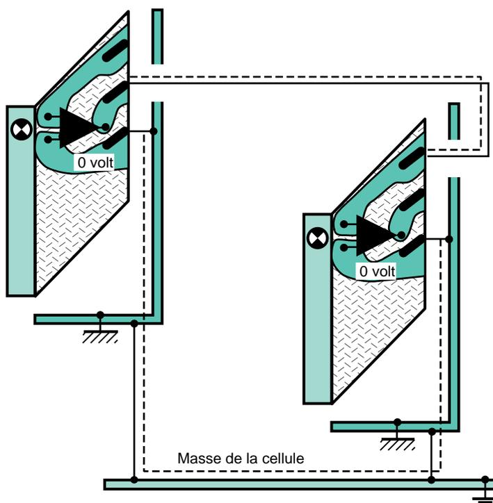
**Fig. 12** : exemple de boucle de masse dans un caisson d'appareillage basse tension d'une cellule moyenne tension.
