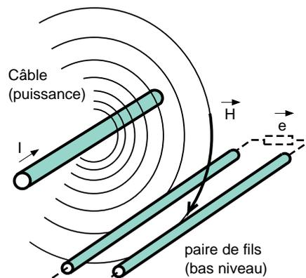
**Fig. 16** : une variation de courant dans un câble génère un champ électromagnétique qui, à faible distance, peut être considéré comme purement magnétique et induit alors une tension perturbatrice dans des fils formant une boucle ; ce mode de couplage est appelé diaphonie inductive.
