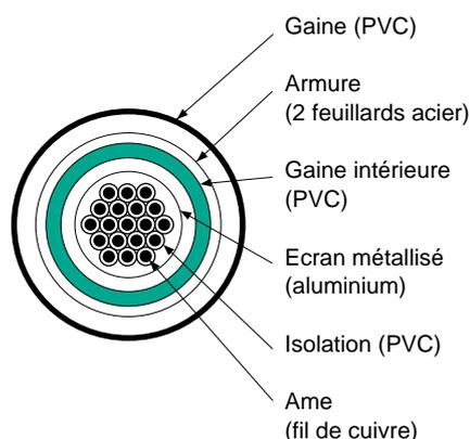
Exemple d'un câble de transport d'énergie moyenne tension
