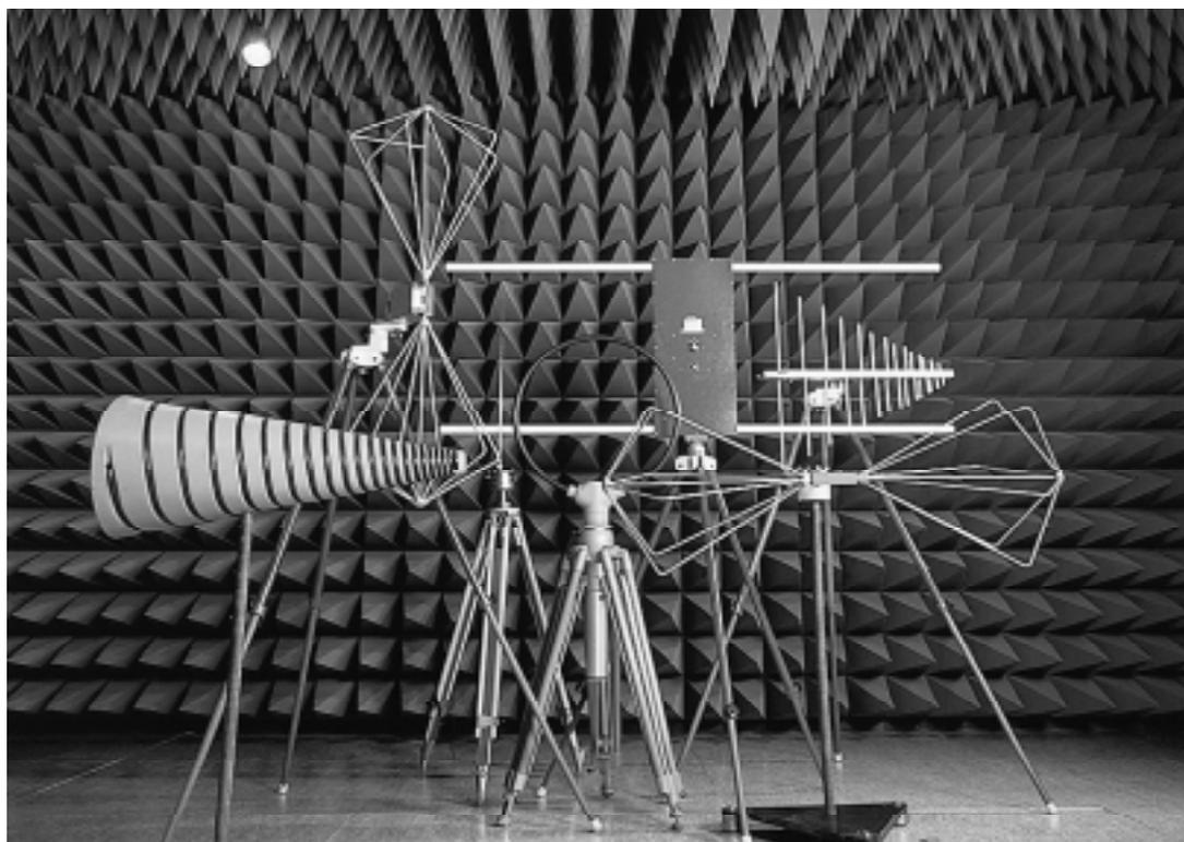
**Fig. 30** : la cage de Faraday semi-anéchoïque et quelques antennes d'un laboratoire CEM de Schneider.
